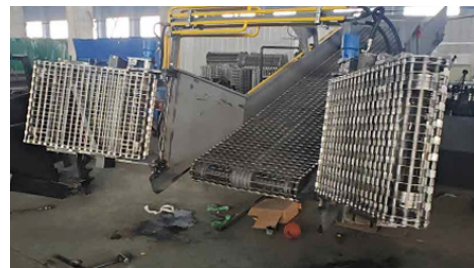
Brazo lateral de recolección accionado por cadena
